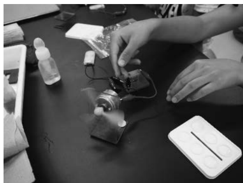
図4 鉛蓄電池を放電している様子
